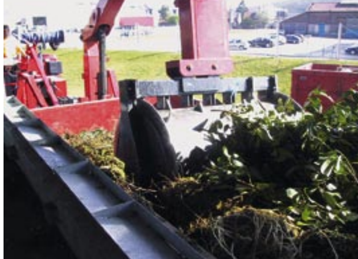
Ill. 10 : Compacter permet d'augmenter de 66% la capacité d'une benne.
